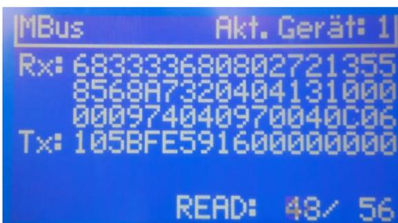
Rechts oben wird die Anzahl der abgefragten M- Bus- Geräte angezeigt.
