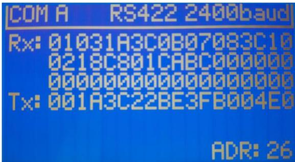
Rechts oben wird die eingestellte Baudrate und der Bustyp angezeigt (eingestellt mit P771 und 772). Rechts unten wird die eingestellte Regleradresse angezeigt (eingestellt mit P770).
