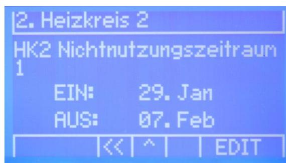
**!ACHTUNG!** Nach abgelaufenem Nutzungs- oder Nichtnutzungszeitraum wird der Zeitraum nicht automatisch zurückgesetzt, die Zurücksetzung muss manuell durch Umstellen des Zeitraums erfolgen.
