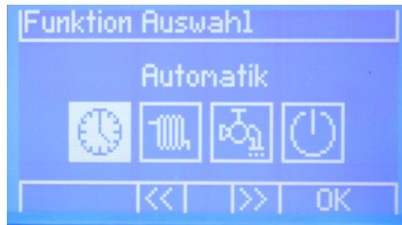
In diesem Untermenü wird der aktuell ausgewählte Betriebsmodus weiß hinterlegt angezeigt, mittels der Pfeiltasten LINKS/RECHTS und ENTER kann ein anderer Betriebsmodus ausgewählt werden.
